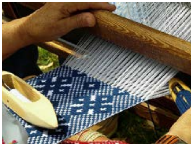
Imagen 12. Telar artesanal actual. Lanzadera para entrecruzar hilos.
