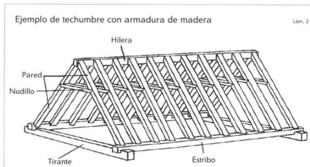
La **armadura de par y nudillo** suponía un estadio de perfeccionamiento, ya que en esencia es idéntica a la de par-hilera, pero reforzada por una viga horizontal, evitando que los pares sufran alabeos. El nudillo va ensamblado a unos dos tercios de la altura de los pares. Así permite mayor anchura del espacio a cubrir. Aparece en el templo de **Moñux**. (Véase lámina adjunta nº 2).
