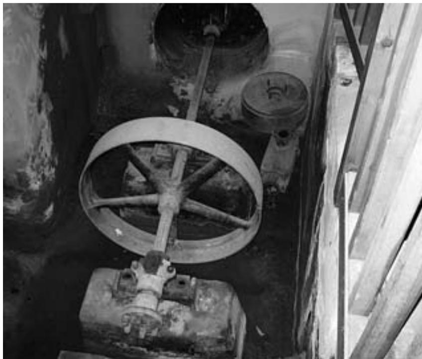
Volante de la turbina que movía el generador del Molino de los Ojos.
