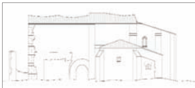
En este alzado se ve como la construcción de la capilla sur y el contrafuerte de la capilla central tapa las dovelas de la puerta, probablemente de época románica.
